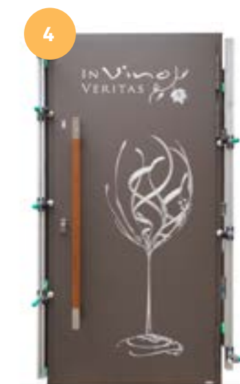
Finální testování hotových dveří ve zkušebním stojanu
